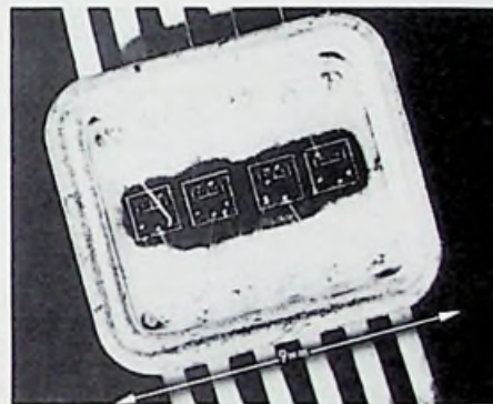
Afb. 13. Hoera voor de TTL-serie. Hier wat wafers van twee inch (het „oude" werk), enkele chip lay-outs, gemonteerde chips op het pennuraampje- of op strip, klaar voor het automatisch afknippen na stempelen.
