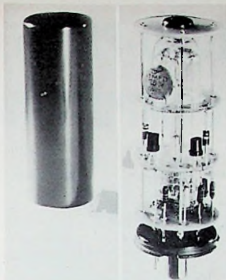
Afb. 11. Integratie, hybride techniek? Hier een tussenvorm: het vacuüm wordt bijgestaan door halfgeleiders.
