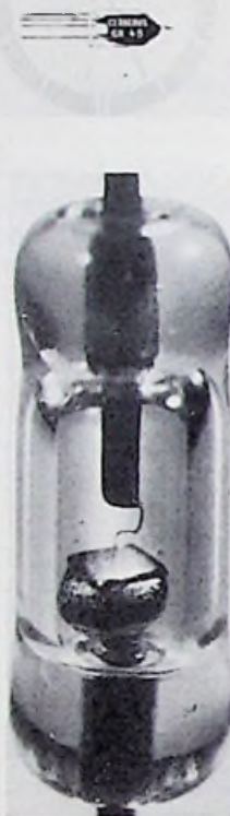
Afb. 8. Nog een interessante buis. Een gasgevulde koude kathode relaisbuis voor schakeltoepassingen, waarvoor „verhitte“ elektronenbuizen niet geschikt zijn. Deze zijn bruikbaar voor alarmeringsdoel-einden en zoals de afb. suggereert zijn er tijdschakelaars mee te realiseren om stappenmotoren voor klokken te sturen.
