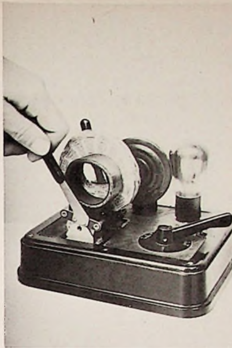
Afb. 14. Oud en nieuw: één-buis ontvanger met afstembare honigraatspoelen uit 1927. Hiernaast een TBA 570, die in z'n centje de buizen ECH 81, EF 89, en EABC 80 vervangt (functies HF oscillator, mengtrap, AM/FM MF-versterker, AM demodulator). Dit bouwsteentje bevat 25 transistoren, 5 dioden, 31 weerstanden en een keramische condensator.
