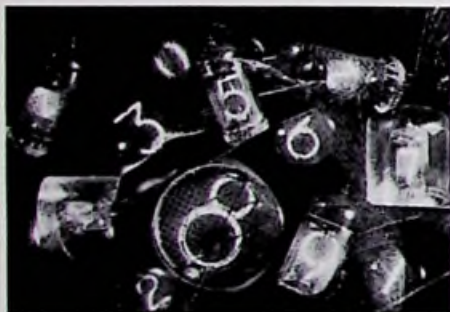
Afb. 6. Een tiental jaren later is de gasgevulde nixiebuis gemeengoed als voorloper van de LED en LCD.
